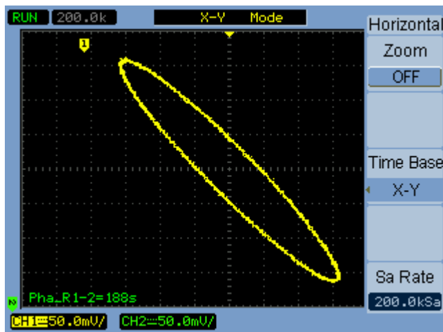
Figura 15 Formato di visualizzazione X-Y che mostra le forme d'onda fuori fase
